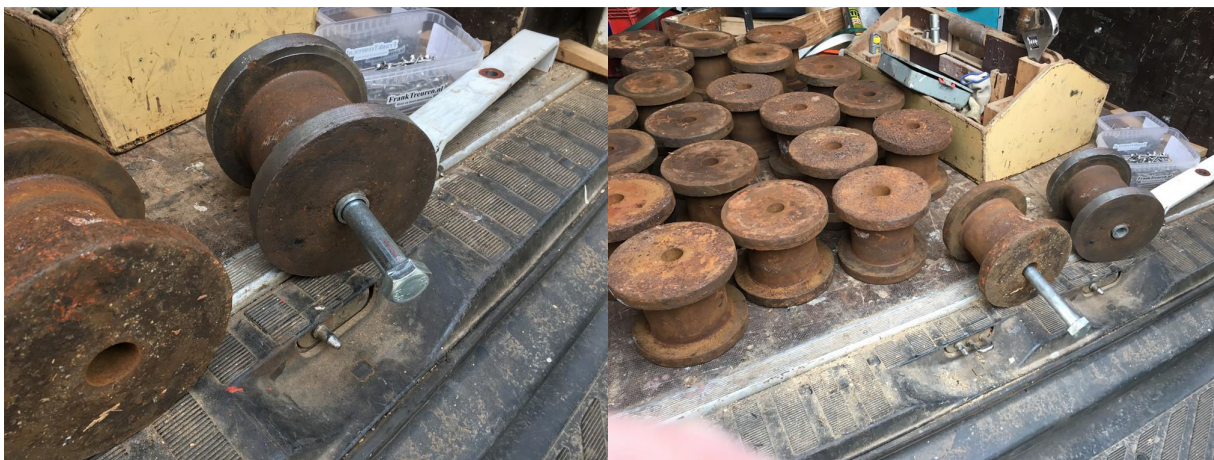
Rond frasen rollen en uitboren lager gaten en vervangen bouten.
